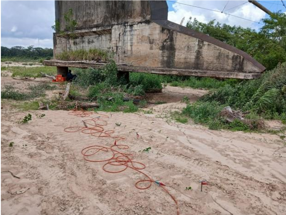
Foto 5: Se observa la base de la Torre sobre dos pilotes y el tendido de línea de tomografía.
